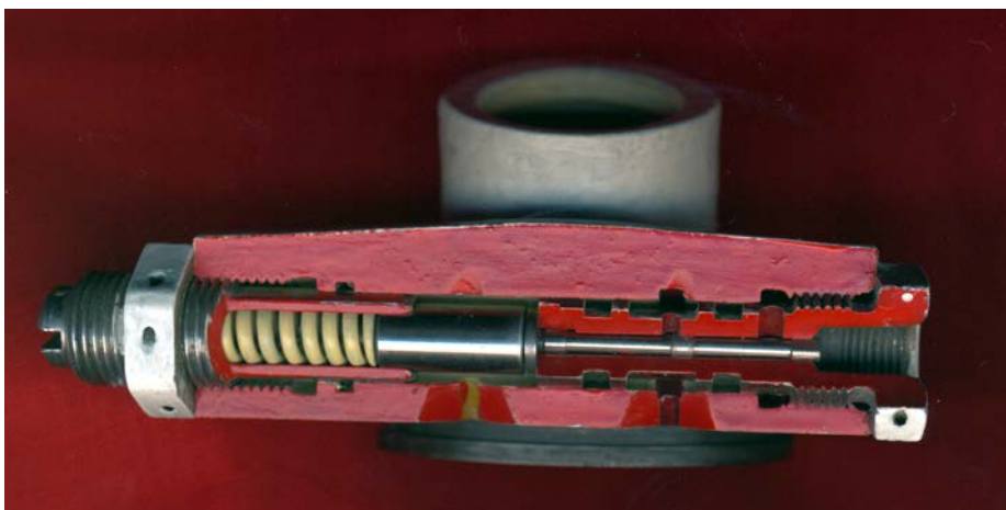
Slika 17. Sklop hidrauličog pretvarača pritiska
