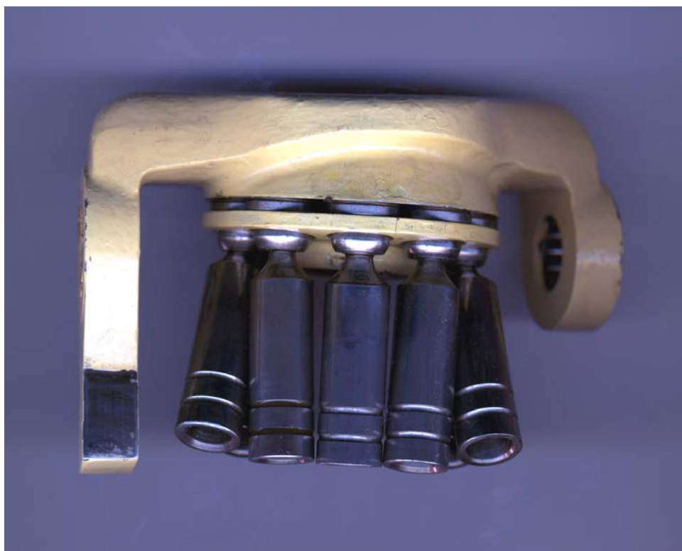
Slika 15. Podsklop, zakretna ploča, klipovi sa papučicama i držač papučica
