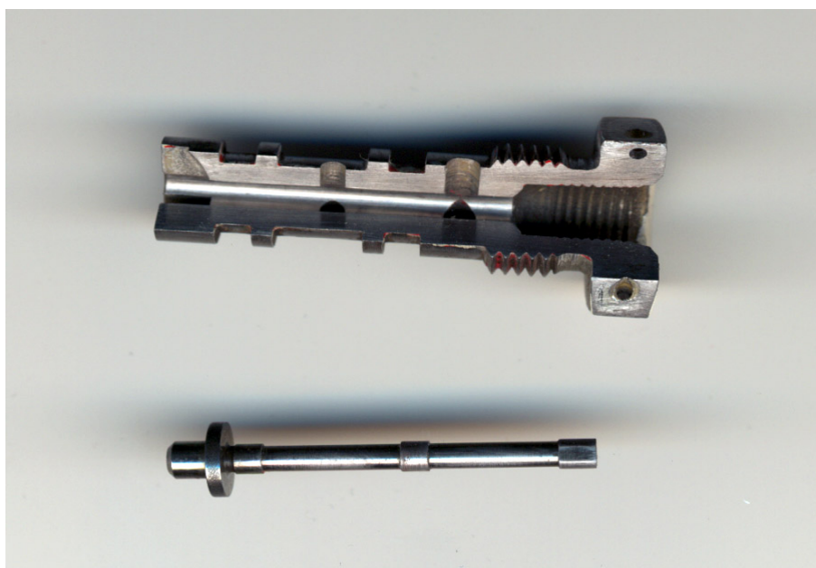
Slika 19. Detalji razvodnika za regulisanje, klip i čaura
