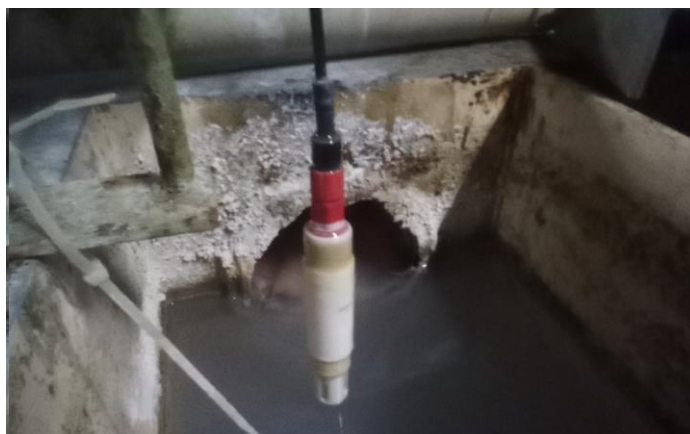
Слика 3.15. рН електрода која је инсталирана у постројењу.
