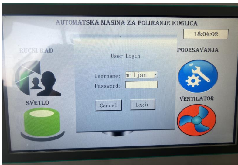
Слика 3.29. Оператерски интерфејс HMI уређаја који је инсталиран у постројењу.
