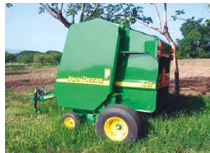
MAQUINA HENIFICADORA DE PASTO EN FORMA DE ROLLOS PARA OFRECERSE EN LAS EPOCAS DE ESTIAJE
