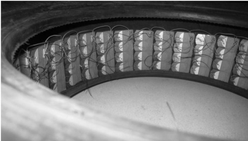
Gambar 6 Piezoelektrik didalam ban
