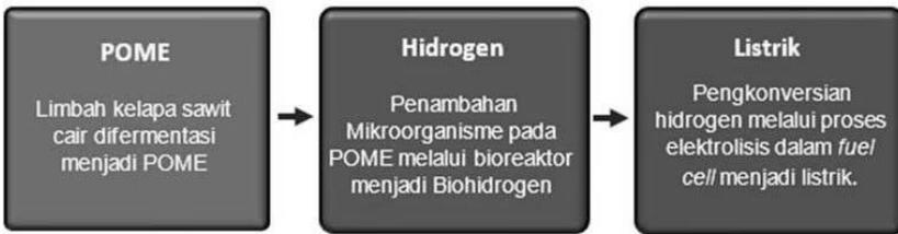
Gambar 3. Skema Penghasil Energi Biohidrogen
