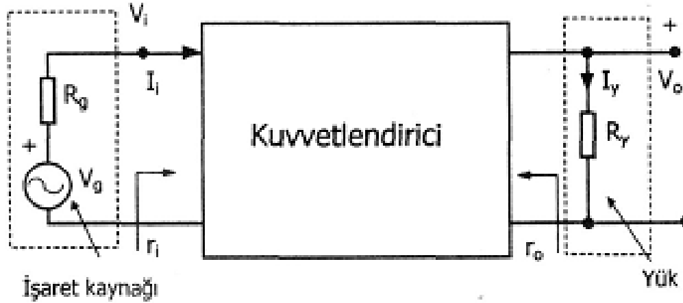
Şekil 4.1 İki kapılı yükselteç (kuvvetlendirici) devresi
