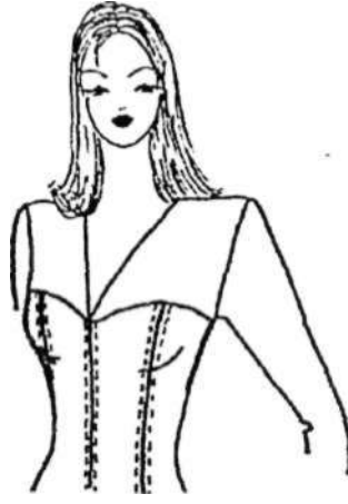
Şekil 12. Üstten çift sıralı dikiş uygulaması
