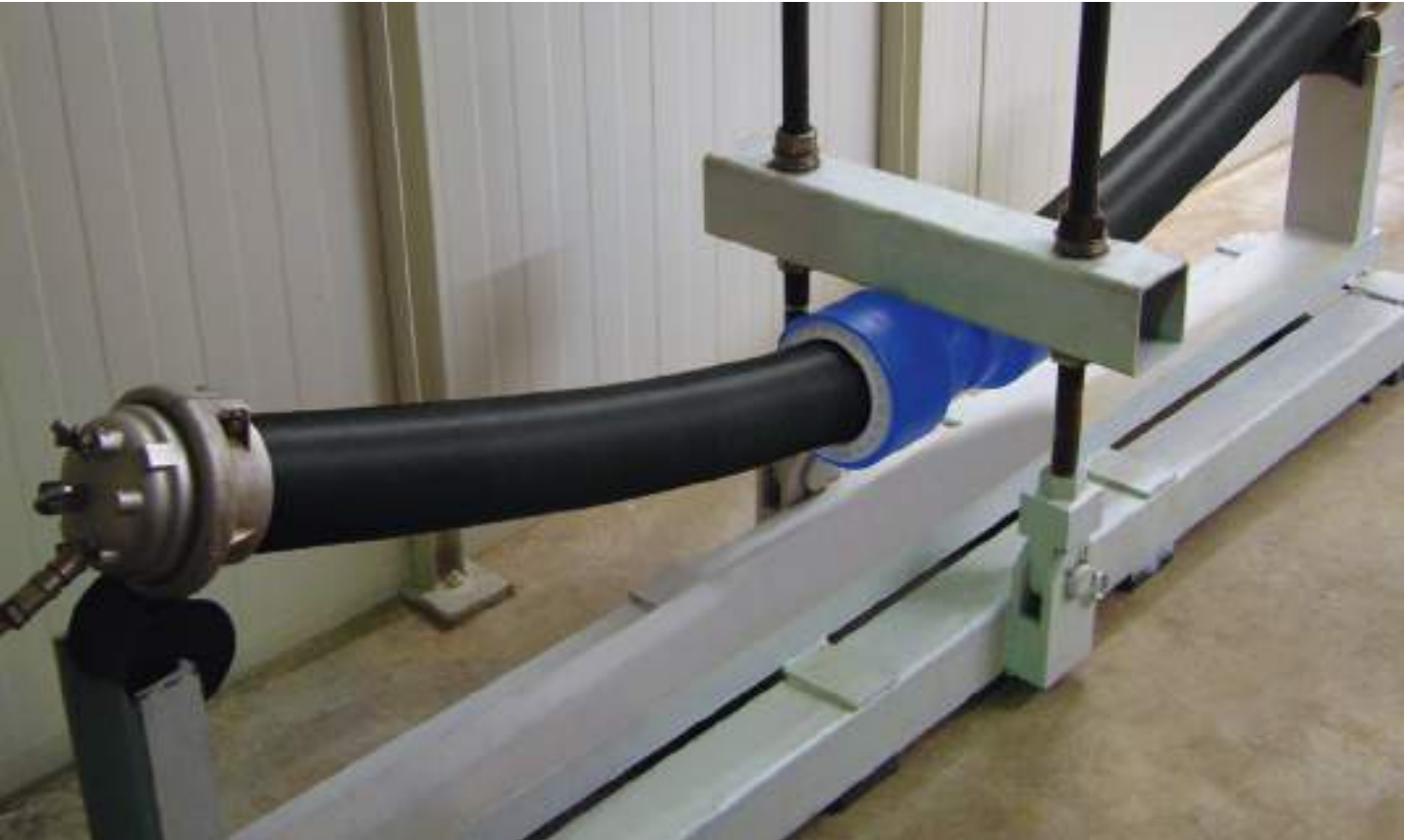
Biegeprüfung unter Prüfdruck von 30,4 bar. | Bending test with internal test pressure of 30,4 bar
