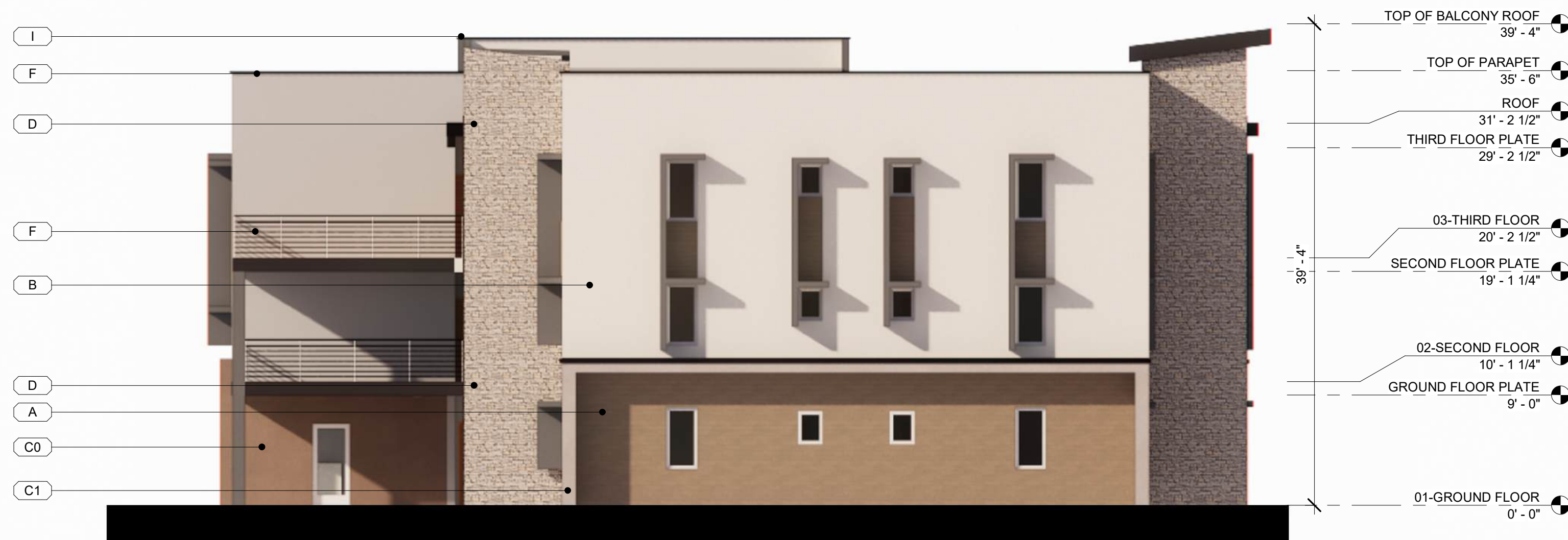
1 EAST ELEVATION (SIM. BLDG 5) SCALE: 1/8" = 1'-0"
