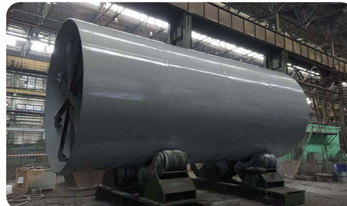
Секция корпуса \varnothing 3600 \times 25 \times 8000 с распорной системой и покраской
