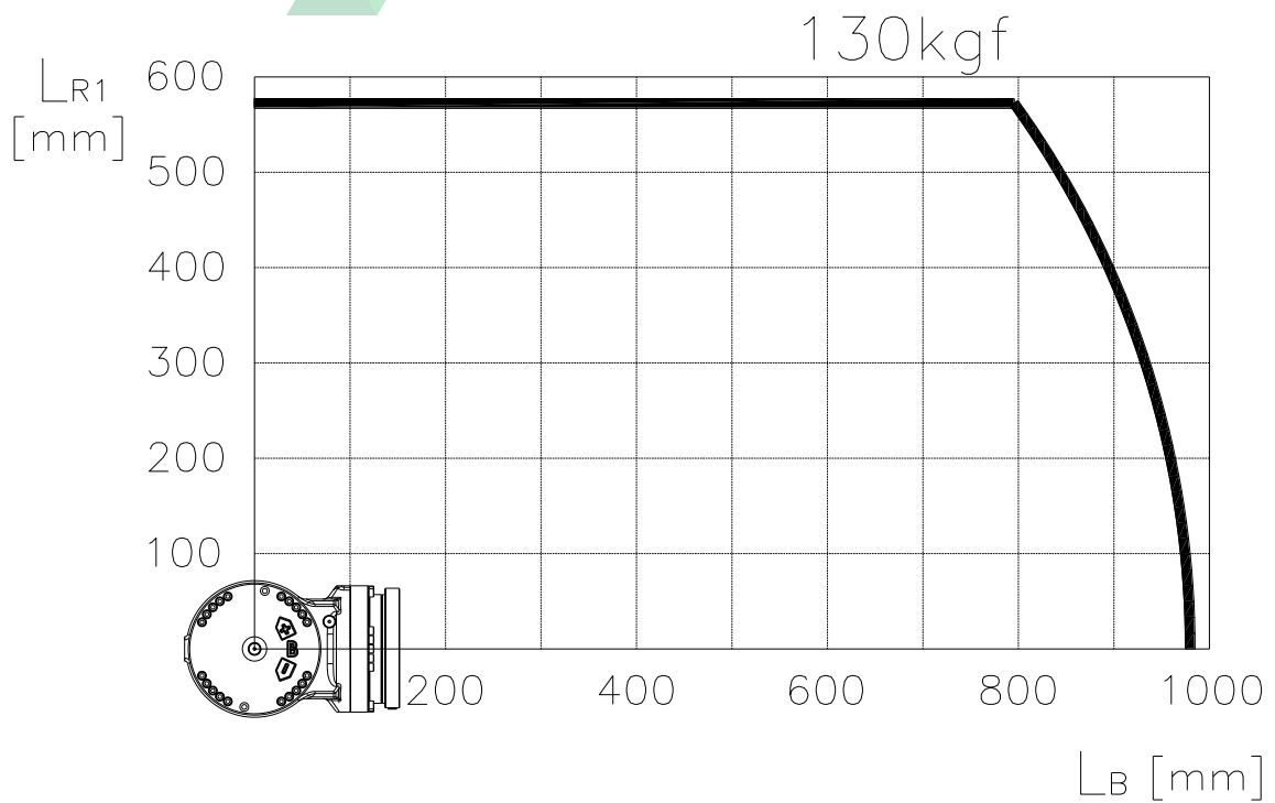
그림 3.11 손목축 토크 선도 (HH130SL/HH150L)
