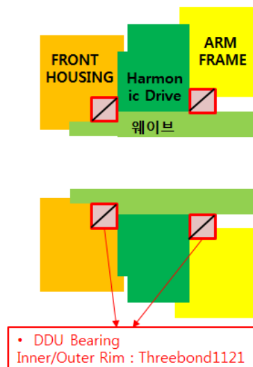
그림 6.13 R2 축 감속기 Threebond 도포 상세도[HH007C]
