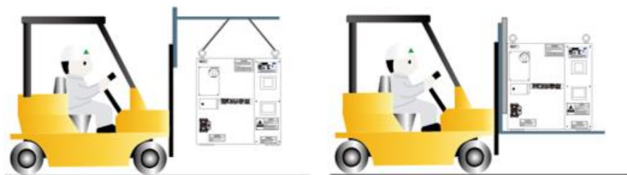
그림 3.4 지게차를 이용한 제어기 운반
