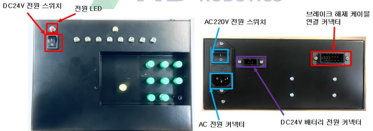
그림 5.4 브레이크 해제 유닛 스위치 및 커넥터
