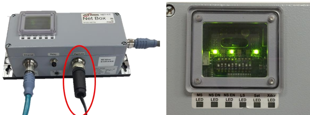
그림 4.4 Net Box 전원 연결, 점등상태 확인
