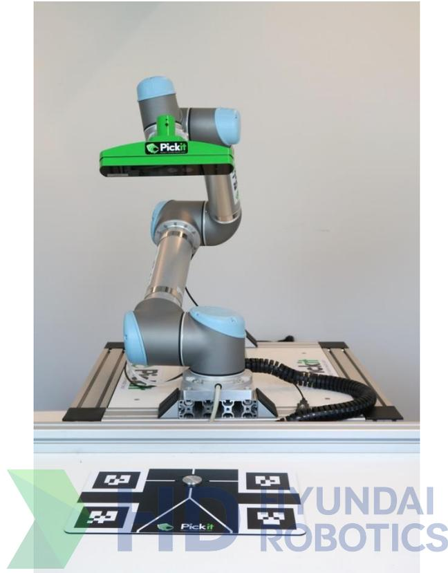
그림 4-4 카메라를 로봇 플랜지에 장착한 경우 예시
