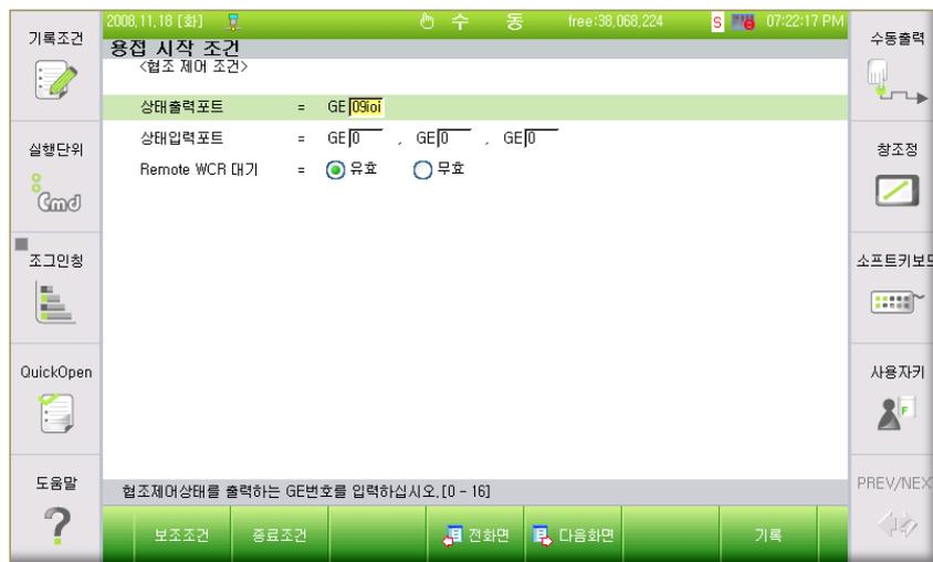
그림 8.16 협조제어 설정 시 ARC 용접 시작조건 대화상자
