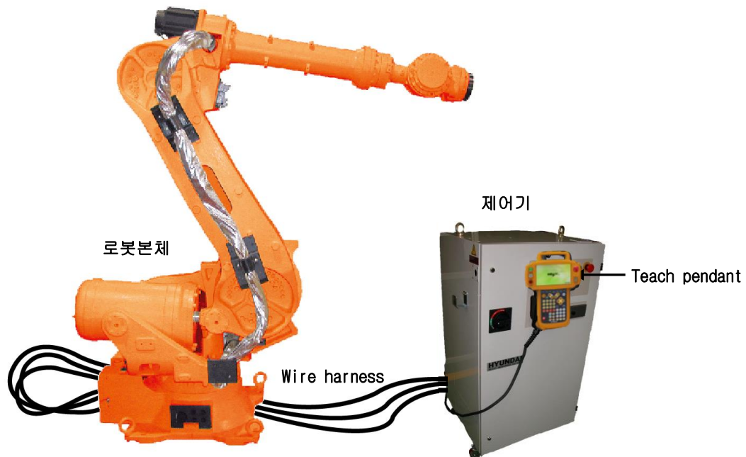
그림 3.2 본체와 제어기의 기본구성 (수직 다관절 로봇)
