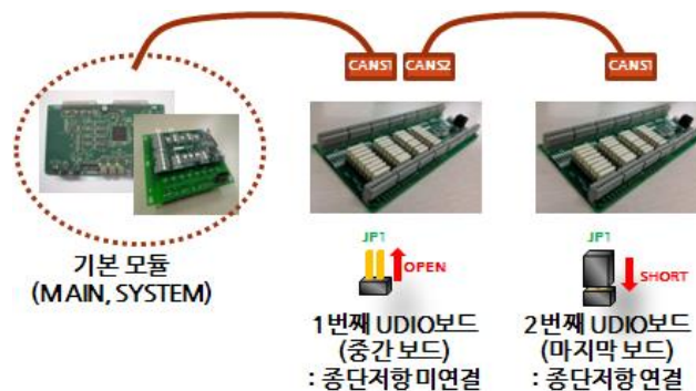
그림 1.239 CAN 통신선로의 종단저항 연결방법
