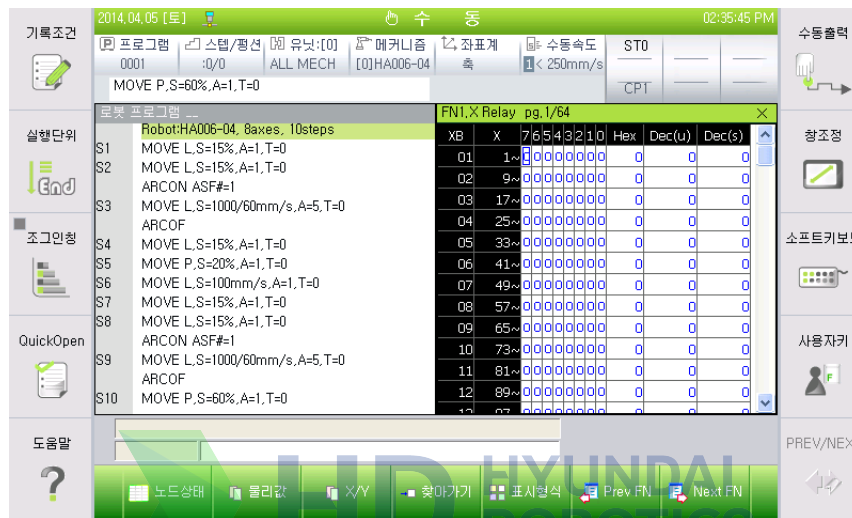
그림 4.24 PLC X Relay(외부입력)
