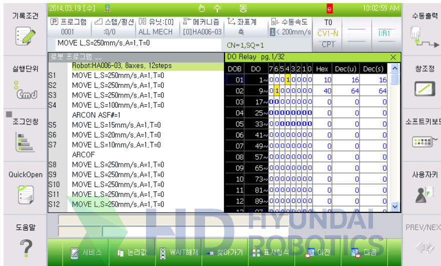
그림 4.32 PLC DO Relay (PLC 입력)
