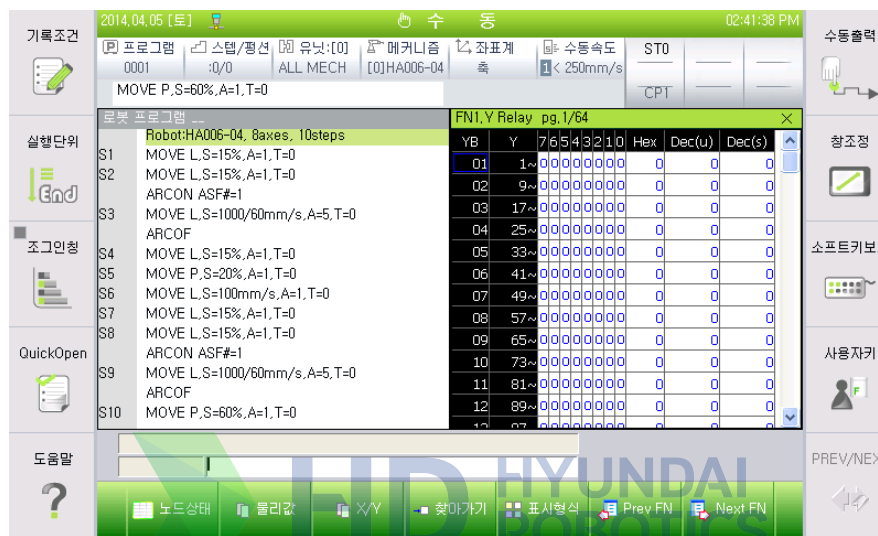
그림 4.25 PLC Y Relay(외부출력)
