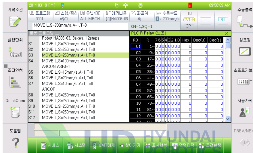
그림 4.26 PLC R Relay(보조)
