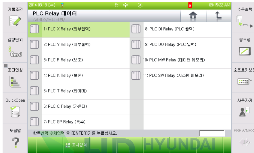
그림 4.23 PLC Relay 데이터 세부항목
