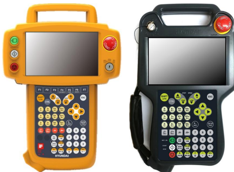
그림 2.4 티치펜던트 (수직 다관절 로봇)
