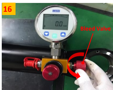
16 Bleed Valve를 Open(반시계방향)하여 PT118 내부에 남아있는 Gas 잔량을 제거하십시오.
