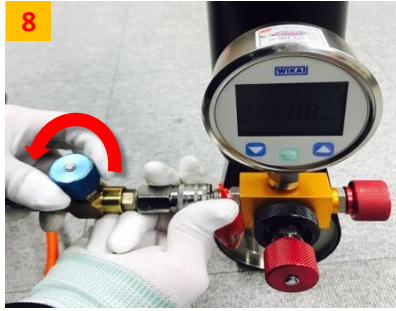
8 S86JN 연결용 Hose에 장착된 Handle을 Open (반시계방향) 합니다.
