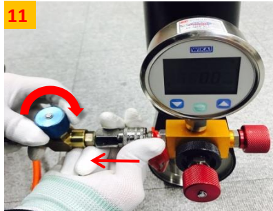
11 S86JN 연결용 Hose에 장착된 Handle을 Close(시계 방향)후 Coupling을 잡아당겨 PT118의 Charging Plug로부터 분리합니다.
