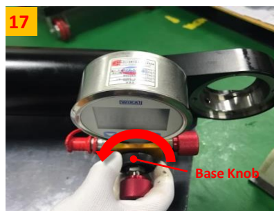
17 PT118의 Base Knob를 반시계방향으로 돌려 Gas Spring으로부터 분리합니다.
