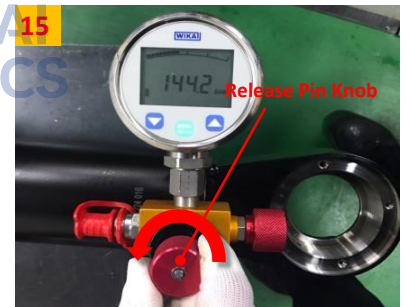
15 Release Pin Knob를 반시계방향으로 돌려 Release Pin을 Check Valve로부터 후퇴 시킵니다.
