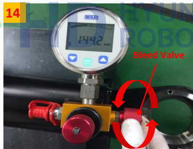
14 Bleed Valve를 서서히 Open/Close를 반복하며 원하는 압력으로 설정하시기 바랍니다.
