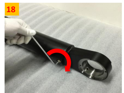
18 Gas Spring의 Gas in/outlet에 Plug를 시계 방향으로 돌려 체결 합니다. PLUG에 오염된 이물은 반드시 제거 후 체결하여 주십시오.
