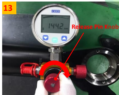
13 PT118의 Release Pin Knob를 시계 방향으로 서서히 돌려 압력을 확인합니다. (Release Pin Knob를 과도하게 돌려 Gas Spring안에 있는 Check Valve를 손상시키 않도록 합니다.)
