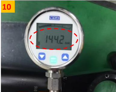
10 설정 압력에 도달하면 순서 9번의 Air Valve를 Close 하여 Booster(S86JN)을 정지 시킵니다.
