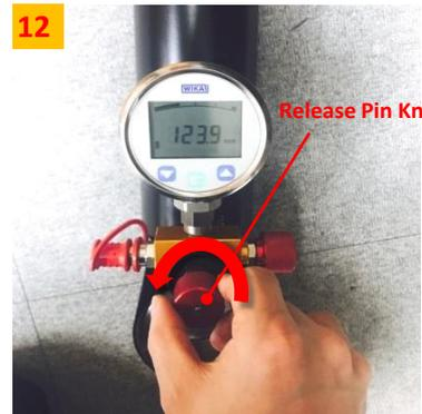
12 Release Pin Knob를 시계 반대 방향으로 돌려 Release Pin 을 Check Valve 로부터 후퇴시킵니다.
