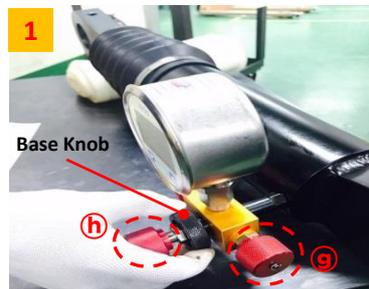
PT118을 Gas Spring의 Gas in/outlet 중심에 위치 한 후 Base Knob를 시계방향으로 돌려 완전히 체결 합니다.
