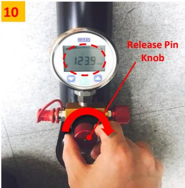
10 PT118의 Release Pin Knob를 시계 방향으로 서서히 돌려 압력을 확인합니다. (Release Pin Knob를 과도하게 돌려 Gas Spring안에 있는 Check Valve를 손상시키 않도록 합니다.)
