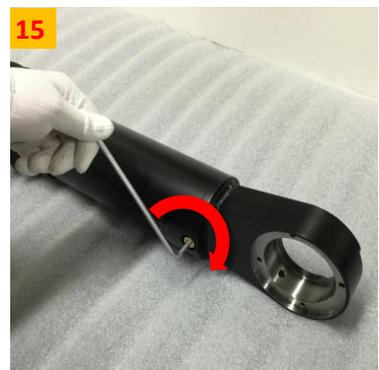
15 Gas Spring의 Gas in/outlet에 Plug를 시계 방향으로 돌려 체결 합니다. PLUG에 오염된 이물은 반드시 제거 후 체결하여 주십시오.
