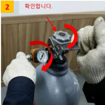
Bombe의 Handle을 시계방향으로 돌려 잠김을 확인한 후, N2 Gas Bombe에 GCH10을 연결합니다. (Spanner 30mm를 이용하여 연결하십시오.)
