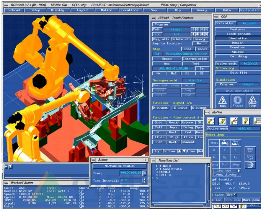
그림 1.1 ROBCAD 환경과 Hi5 OLP Package 의 사용
