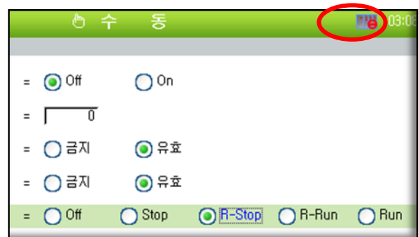
그림 2.3 내장 PLC STOP 상태
