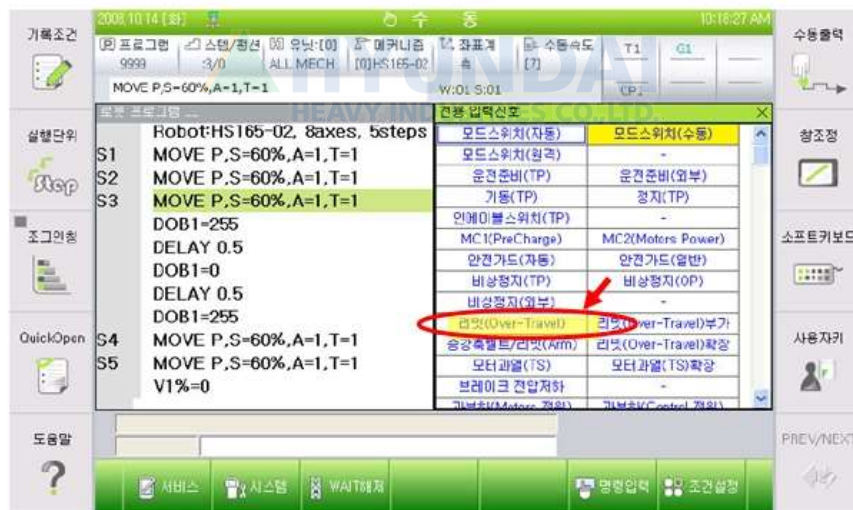
그림 1.128 하드웨어 리밋스위치 입력상태 표시(티칭펜던트 화면)
