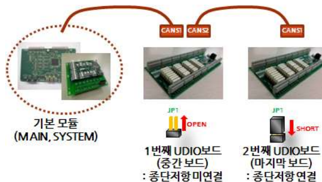
그림 1.30 CAN 통신선로의 종단저항 연결방법
