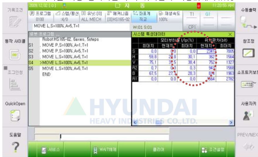
그림 1.178 TP 에서의 위치편차 측정최대치 모니터링 화면
