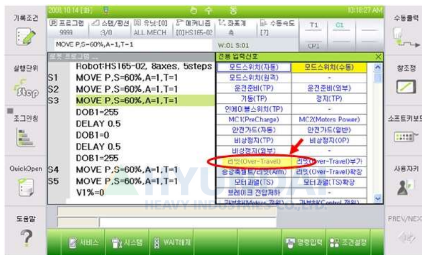
그림 1.3 전용신호 입력창에서 리밋(Over-Travel) 모니터링 표시
