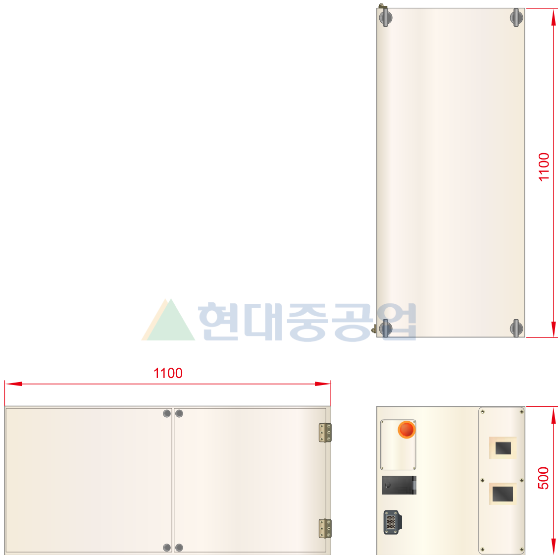
그림 3.16 Hi5-C20 제어기 외형 (단위:mm)
