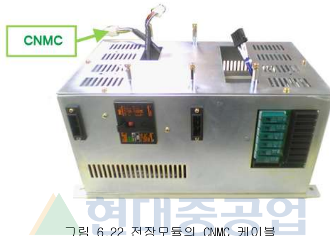
그림 6.22 전장모듈의 CNMC 케이블
