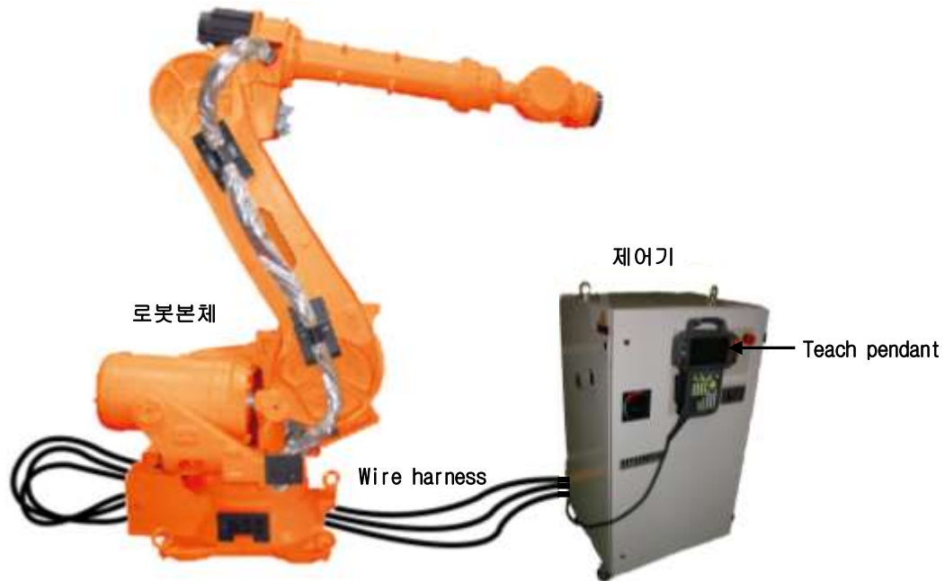
그림 3.2 본체와 제어기의 기본구성 (수직 다관절 로봇)
