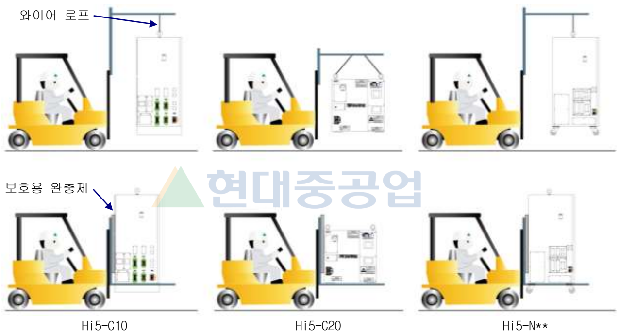
그림 3.11 지게차를 이용한 제어기의 운반
