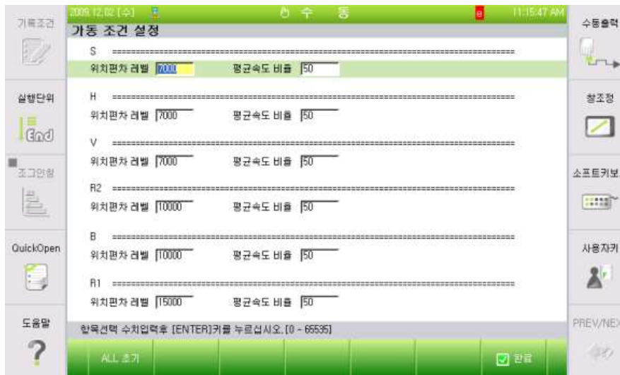
그림 6.85 TP에서의 위치편차 설정치 변경화면
