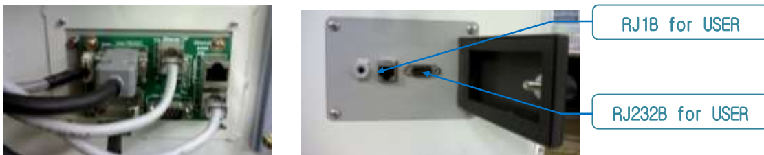
그림 4.62 스몰도어 보드(BD5B1)의 외부 및 내부
