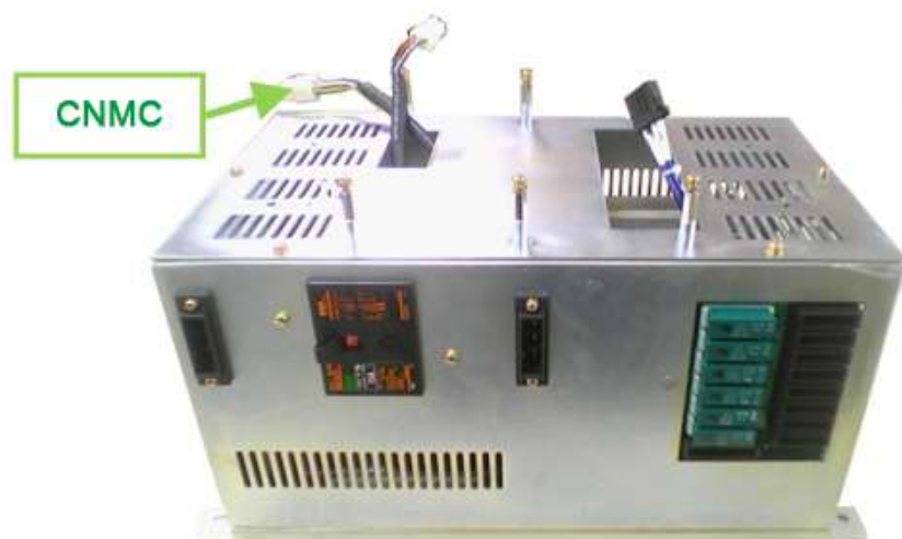
그림 6.105 전장모듈의 CNMC 케이블
