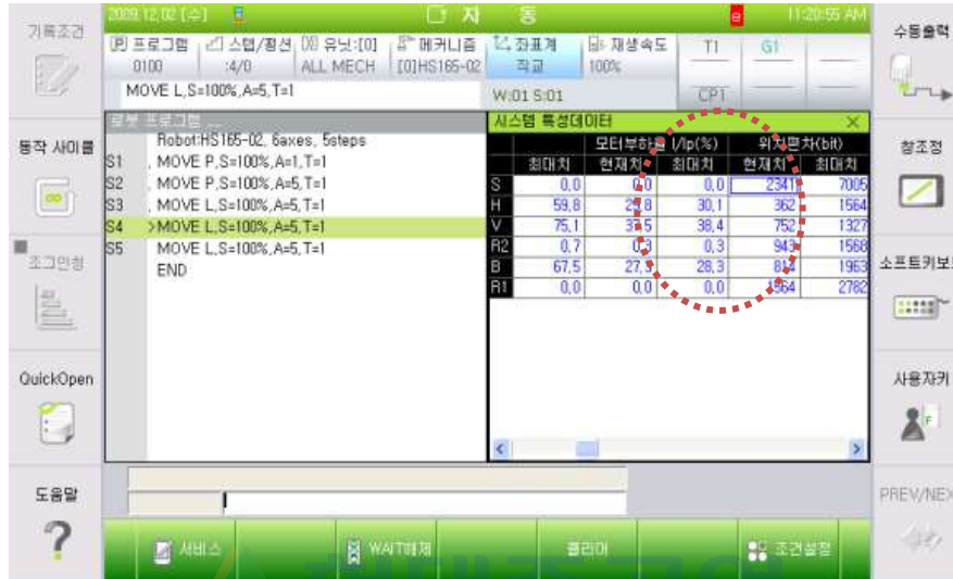
그림 6.84 TP에서의 위치편차 측정최대치 모니터링 화면
