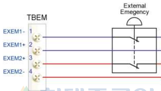
그림 4.29 터미널블록 TBEM 에 외부비상정지 스위치를 연결하는 방법
