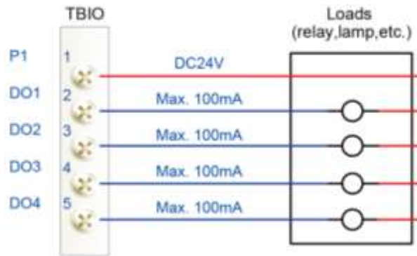
그림 4.44 터미널블록 TBIO 에 시스템 전용 디지털출력을 연결하는 방법
