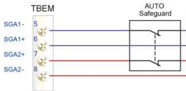
그림 4.36 터미널블록 TBEM 에 점점입력 자동 안전가드를 연결하는 방법
