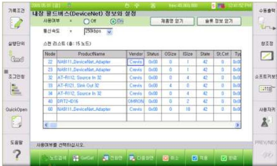
그림 7.9 내장 필드버스 설정의 노드스캔 결과-1
