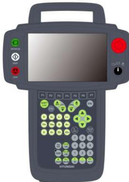
그림 2.2 티치펜던트 (LCD 로봇)
