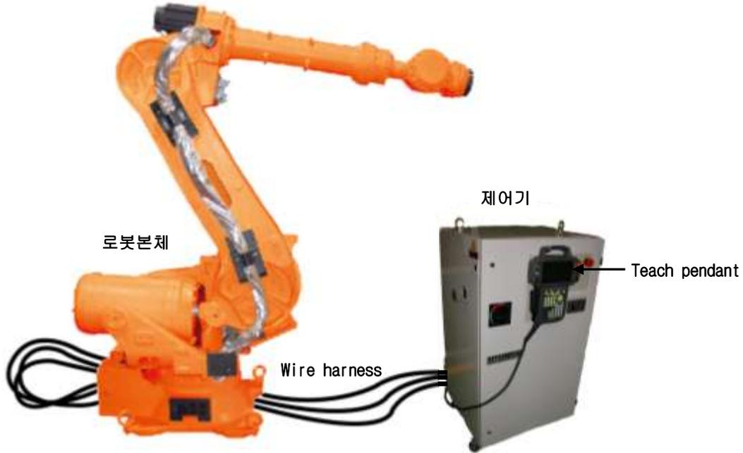
그림 2.3 로봇 시스템의 기본 구성도 (수직 다관절 로봇)
