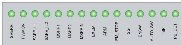
그림 4.27 시퀀스보드 BD461V31 에서의 LED 배치
