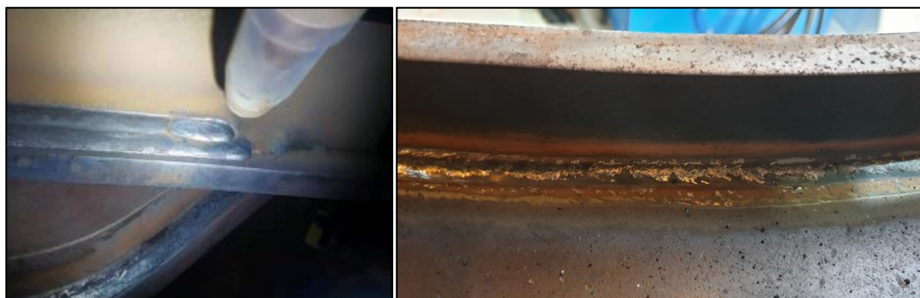
Figure 3.2 Actual multipass welding
