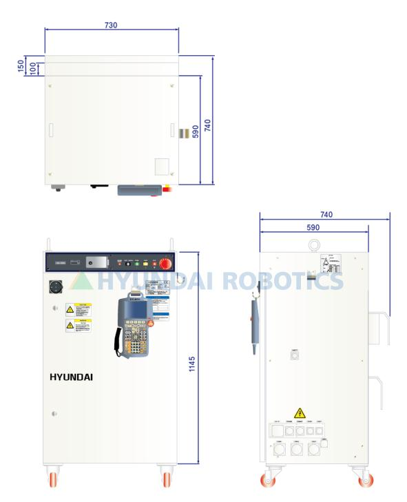
Fig. 3.12 Dimension of Hi4a(Unit:mm) Hi4a-P000
