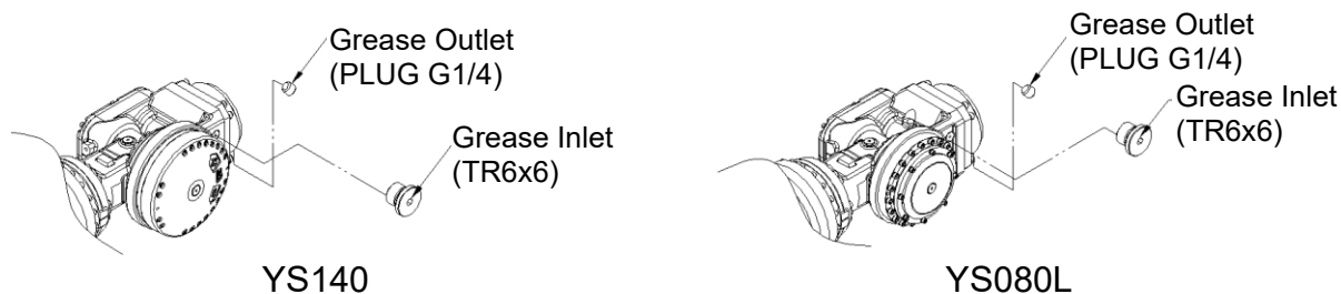
图 5.7 R1 轴减速机润滑油注入/排油口
