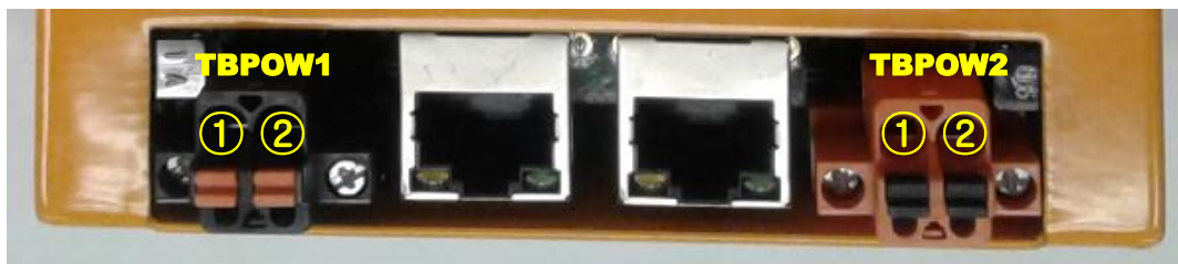
图 2.5 SafeSpace 电源连接
