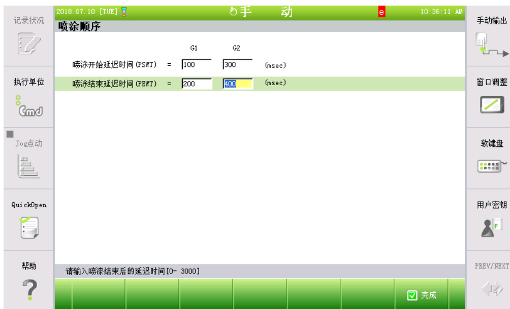
图 3.4 Atom/Spray（涂装顺序）输出信号时序对话框
