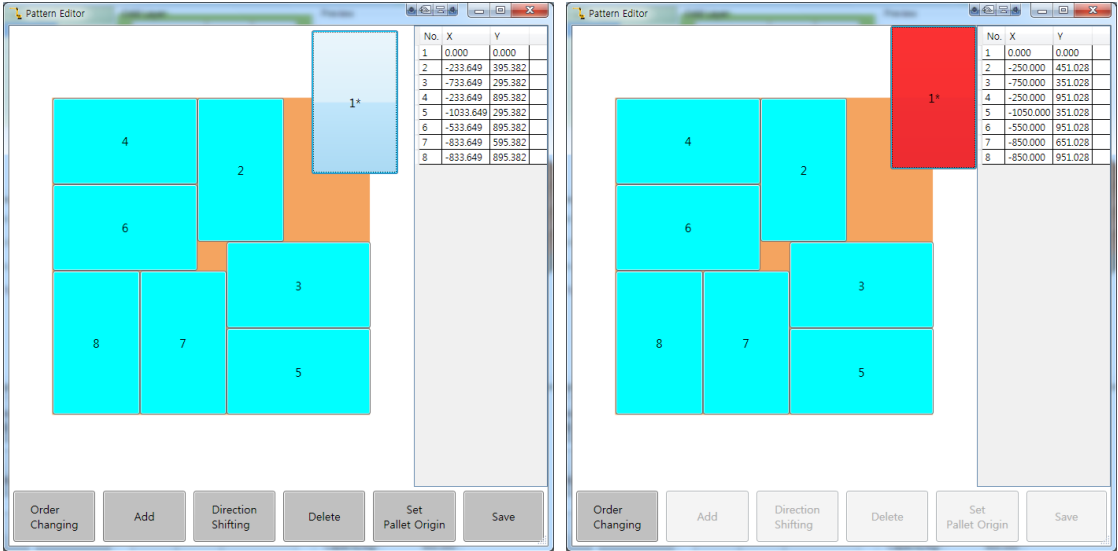
图 3.9 堆码物的重量重心移到托盘领域外的情况
