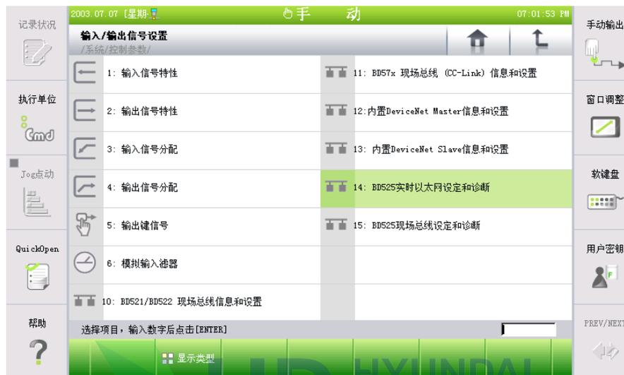
图 3.1 实时以太网设置和诊断菜单
