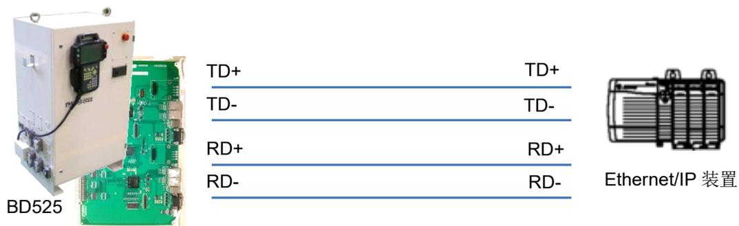
图 2.4 Direct 电缆连接
