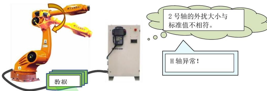
图 1.1 驱动单元异常检测功能的概念图
