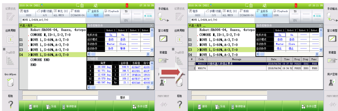
图 5.6 对象机器人停止时输出警告
