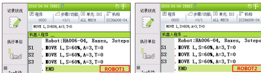
图 2.7 不同机器人的共同坐标系设置程序
