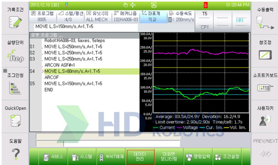
图 7.7 电弧焊数据控制功能进入画面
