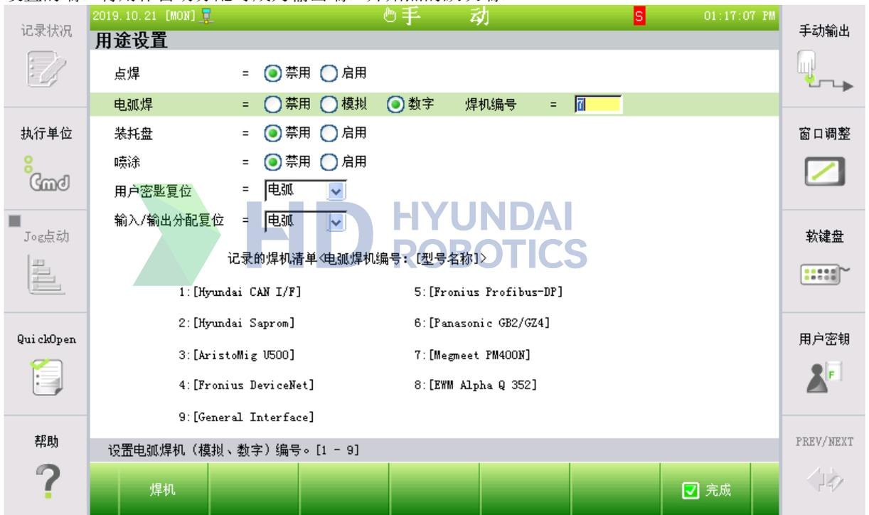
图 4.6 Megmeet 焊机条件设置
