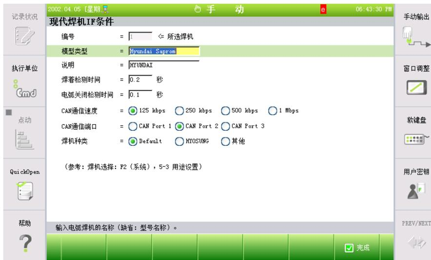
图 4.2 如何输入焊接设置对话框(数字 HRWI 例示)
