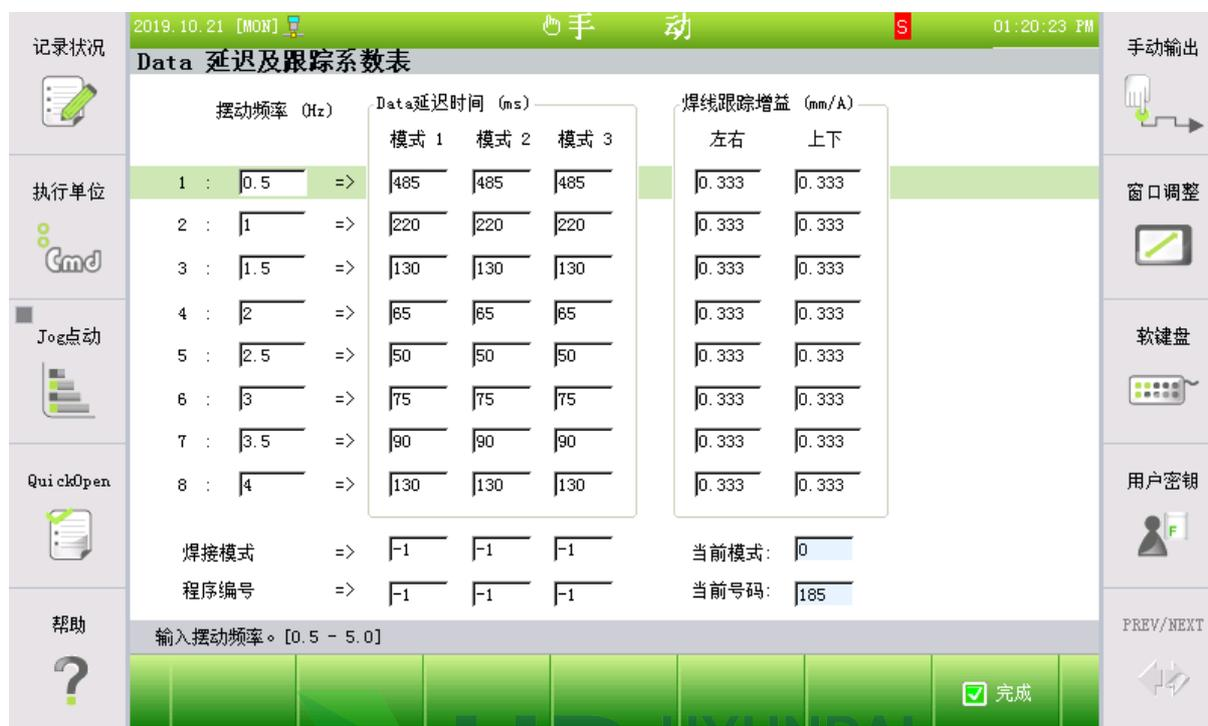
图 8.3 电弧传感条件-工程师对话框
