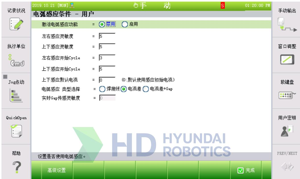
图 8.1 电弧感应/对话框
