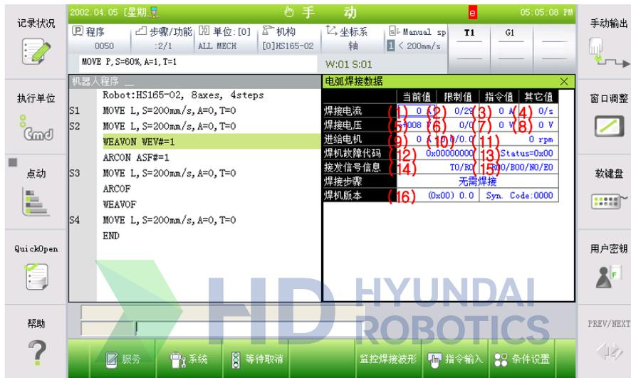
图 7.1 Arc 焊接监控具体信息
