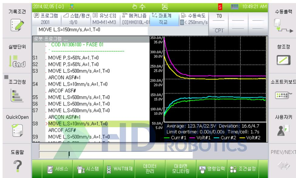
图 7.9 电弧焊数据比较功能
