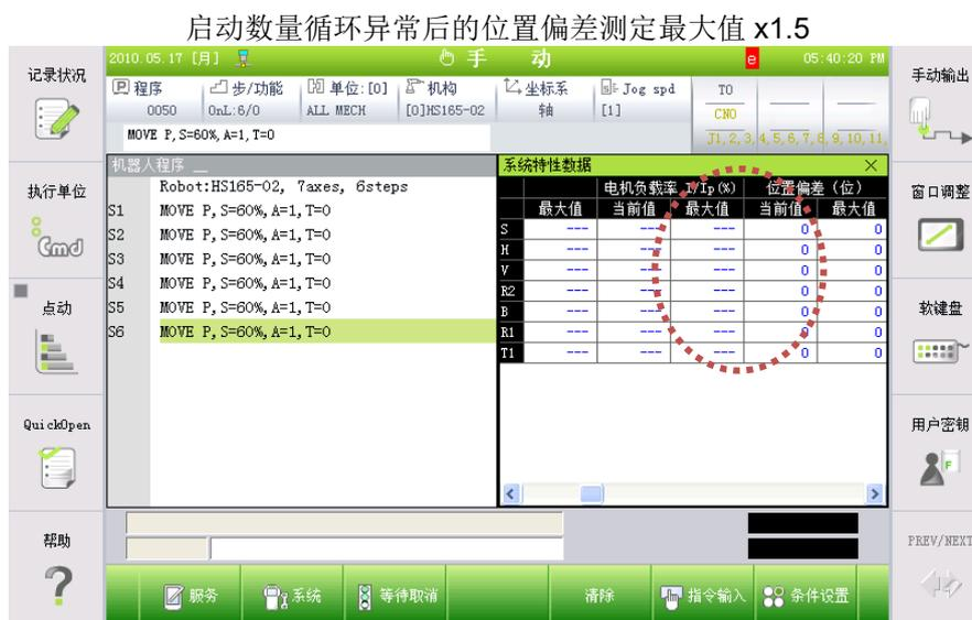
图 1.72 在 TP 的位置偏差测定最大值监测画面
