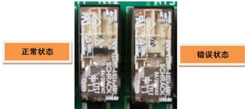
图 1.139 BD58B 板的继电器的正常与错误状态比较
