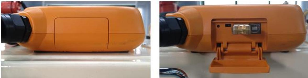
图 1.80 在示教器上插入 USB 的方法
