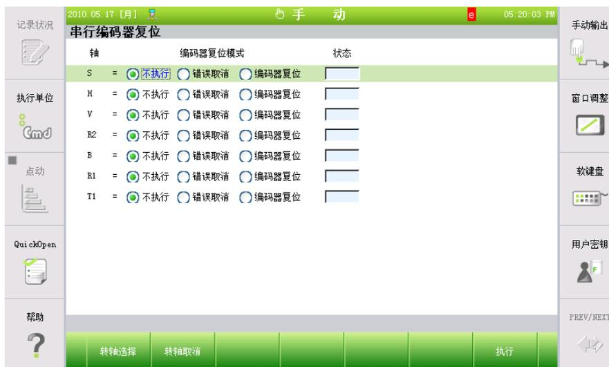
**(2) 请检查编码器电池接线状态。**
