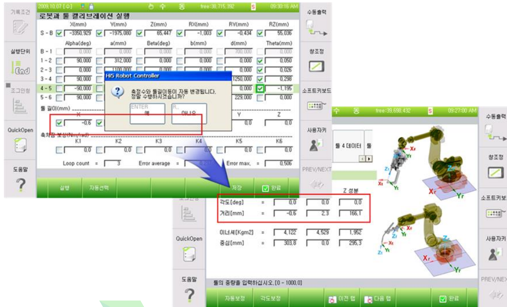
图 7.109 执行机器人校准的画面
