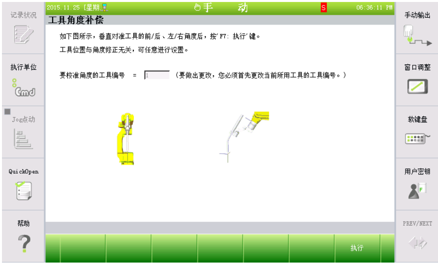
图 7.59 工具角度校准画面
