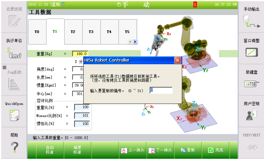
图 7.60 工具角度校准画面
