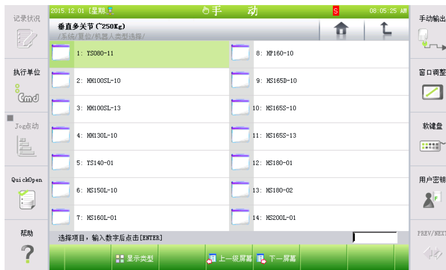
图 7.83 选择垂直多关节机器人类型
