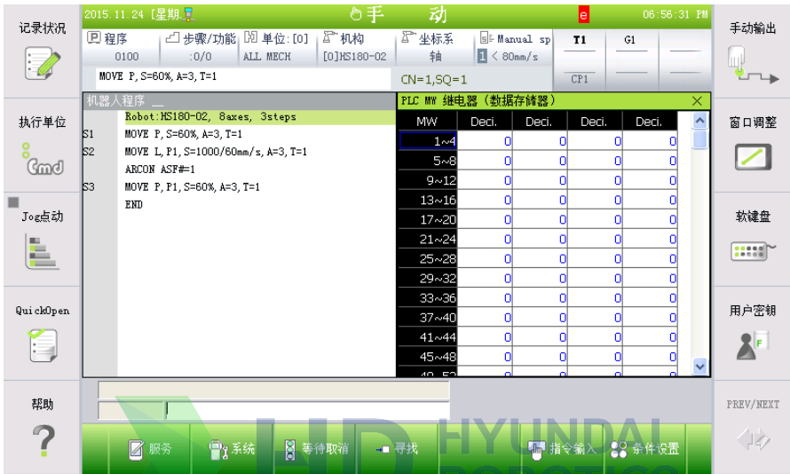
图 4.33 PLC MW 继电器 (数据存储器)
