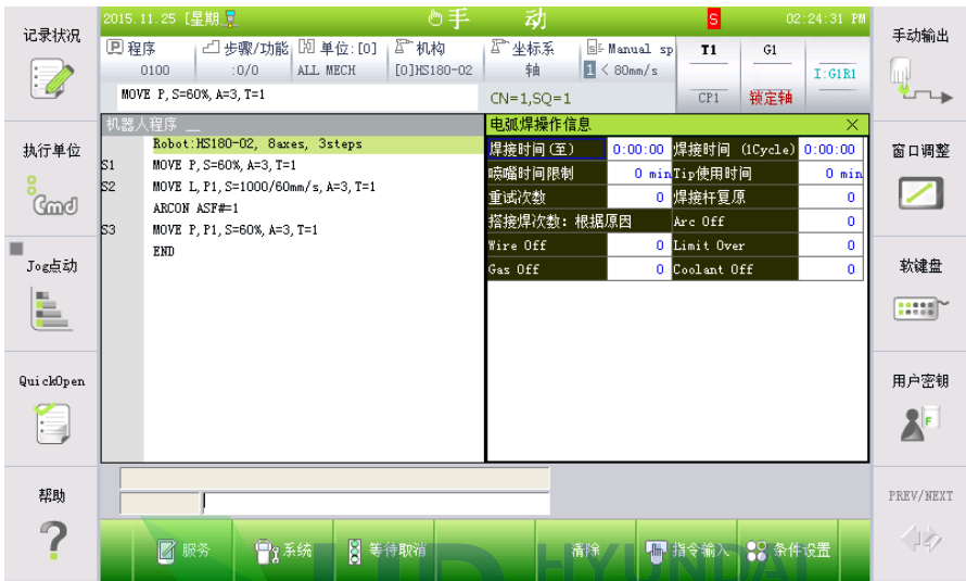
图 4.51 电弧焊运转信息监测
