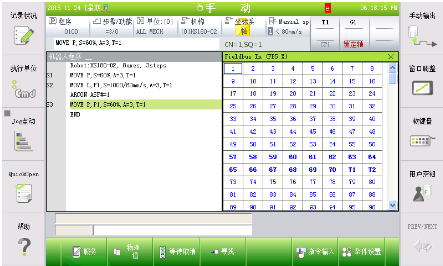
图 4.16 FB5 现场总线输入/输出监测
