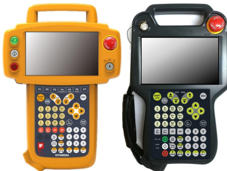
图 2.4 示教盒(垂直多关节机器人)
