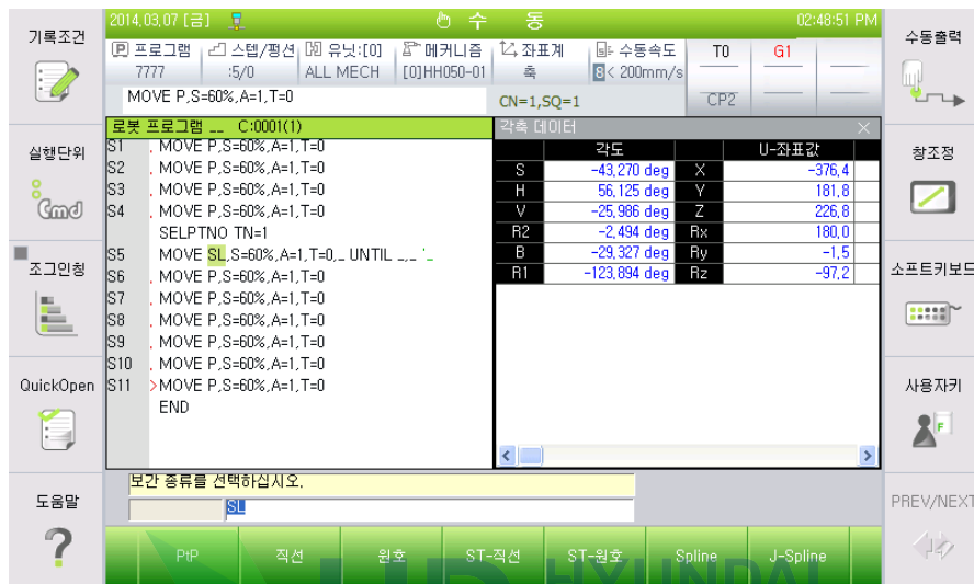
图 7.41 固定工具坐标系使用程序制作示例
