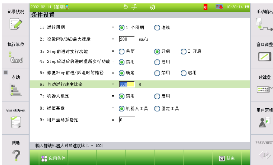
图 2.28 自动操作速度比率的设置画面
