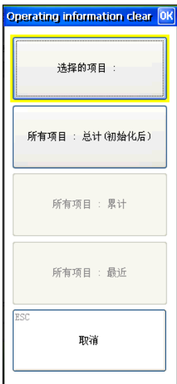
图 4.52 电弧焊运转信息清除对话框
