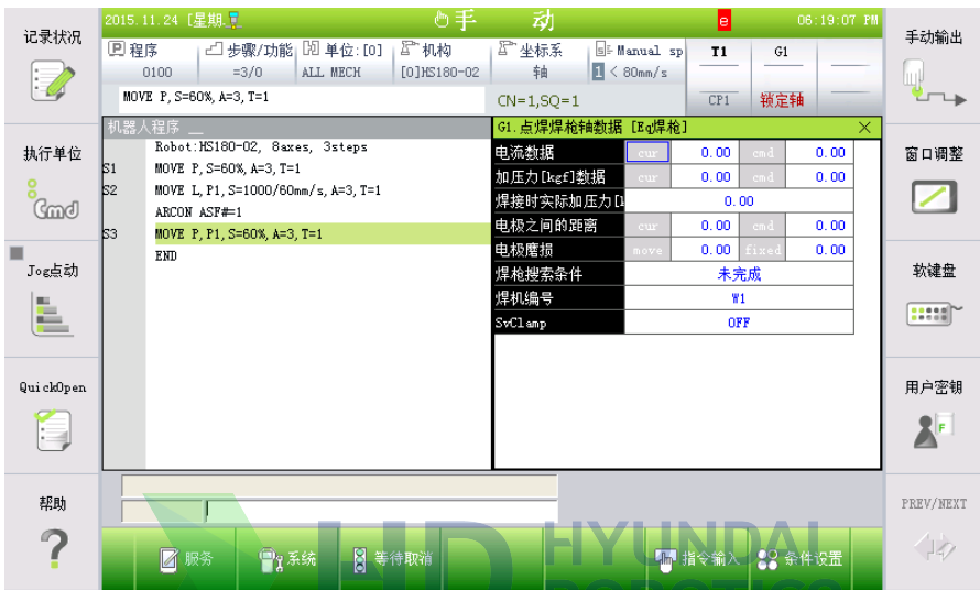
图 4.18 点焊焊枪轴数据
