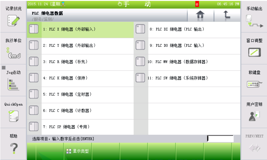
图 4.23 PLC Relay 数据详细项目
