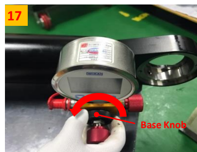
向逆时针方向转动PT118的Base Knob, 从气弹簧分离。
