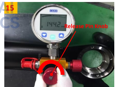
向逆时针方向旋转Release Pin Knob, 使Release Pin从Check Valve后退。
