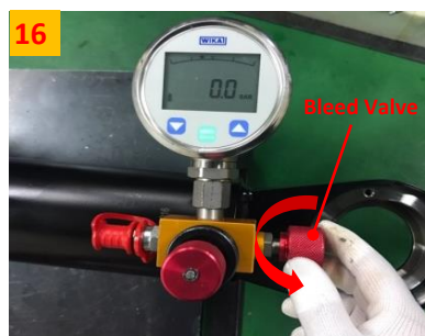
打开 Bleed Valve(逆时针方向), 放出PT118内部剩余的残压。
