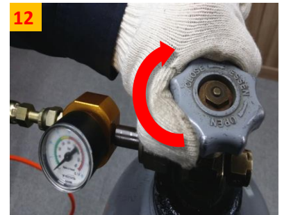
Close (顺时针方向) N2 Gas Bombe的Handle。
