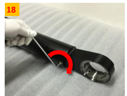
在Gas Spring的Gas in/outlet上向顺时针方向旋转Plug进行拧紧。请务必清除PLUG上被污染的异物后再拧紧。
