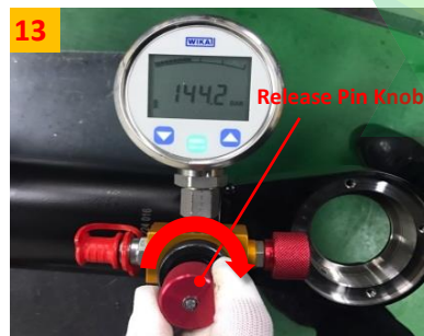
向顺时针方向慢慢旋转PT118的Release Pin Knob, 确认压力。(请注意不要过度转动Release Pin Knob, 以免损坏气弹簧上安装的检验阀。)
