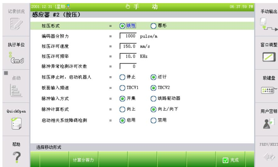
Press 同步是随着 Press 的速度机器人同步作业。假设 Press 的速度始终固定、Press 的速度可变时同步性能就会降低。当前运行的 Press 速度在上述菜单下设定为 Press 容许速度。
