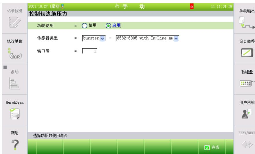
图2.2 Roller hemming 加压力控制设为‘启用’的画面
