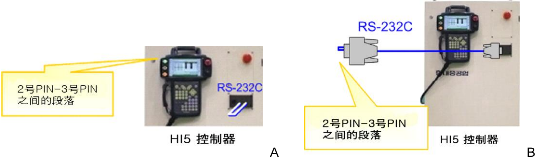
图 3.12 控制器贮存柜侧 RS-232C 收发报段落
