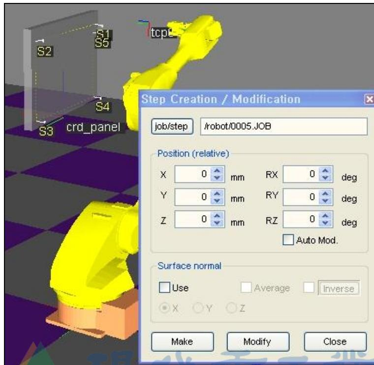
示教结束后进行模拟。如果结果正常、变更 Panel 的位置/方向后在机器人属性的坐标系页面点击‘以 VRC 进行反映’键后重新进行模拟。可以看到以变更前相同的 Panel 表面位置移动工具末端。
