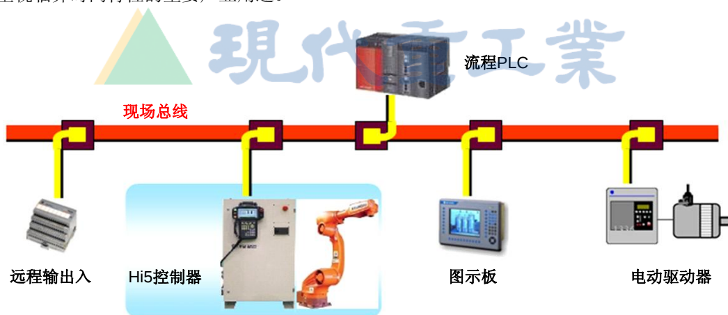
图 1.1 Fieldbus(现场总线)网络和主站、从动(slave)装置
