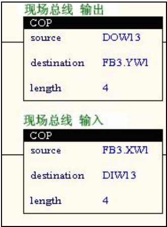
图 6.2 把机器人语言输入输出在 Fieldbus(现场总线)上贴图的内装 PLC Ladder 的例如
