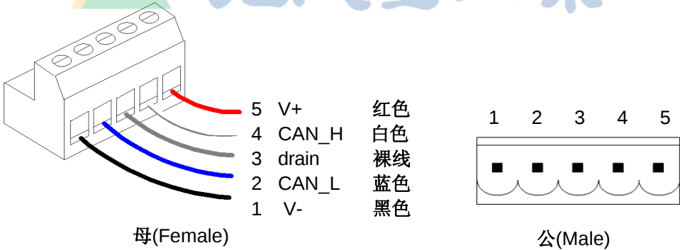
图 2.1 设备网(DeviceNet)开放型连接器引脚(pinout)
