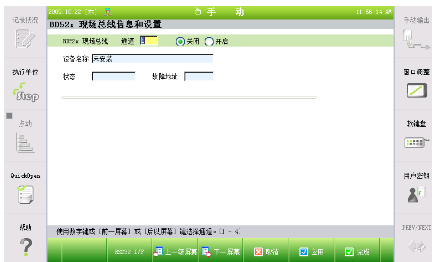
图 4.2 BD52x Fieldbus(现场总线)信息及设置界面
