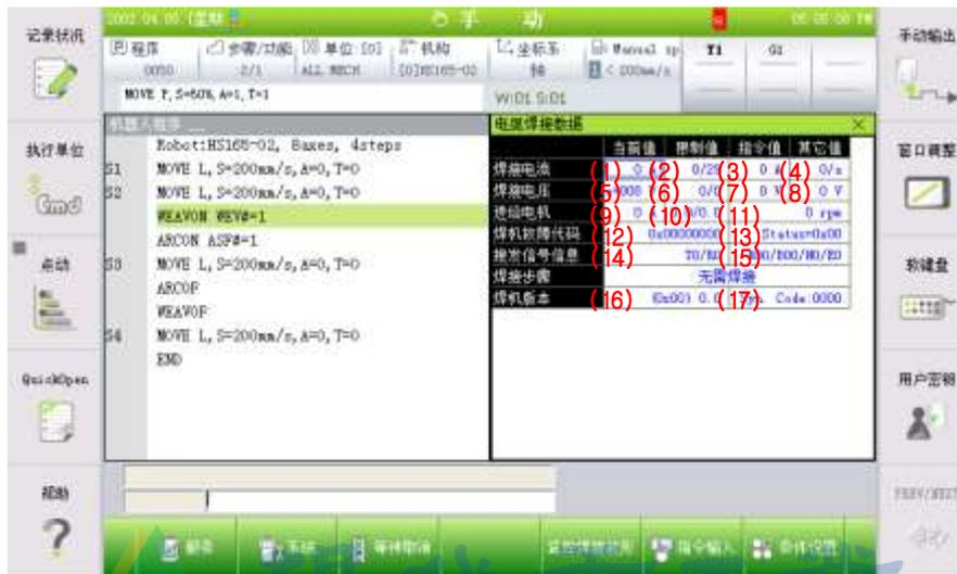
图 11.1 Arc 焊接监控具体信息
