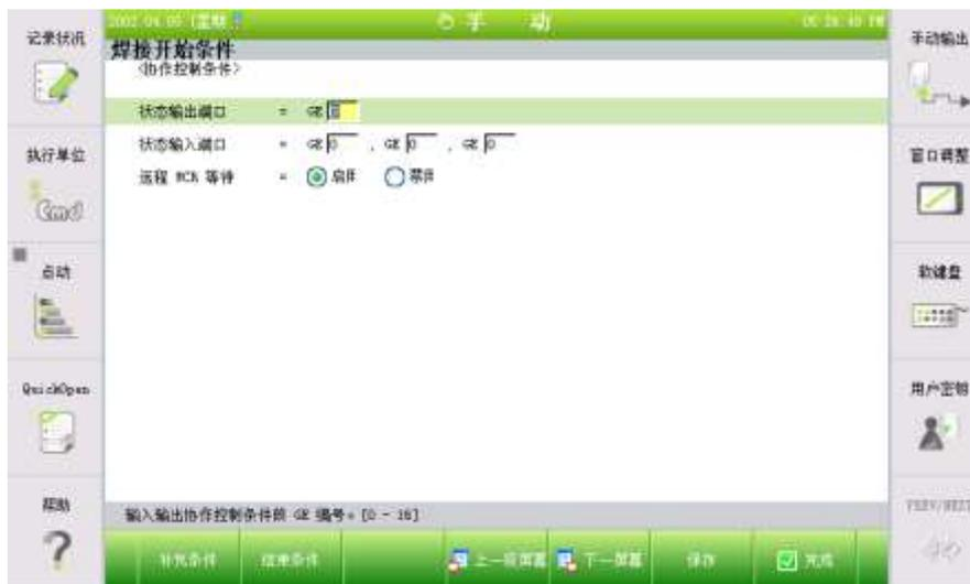
图 12.2 辅助控制设置时的 ARC 焊接开始条件对话框
