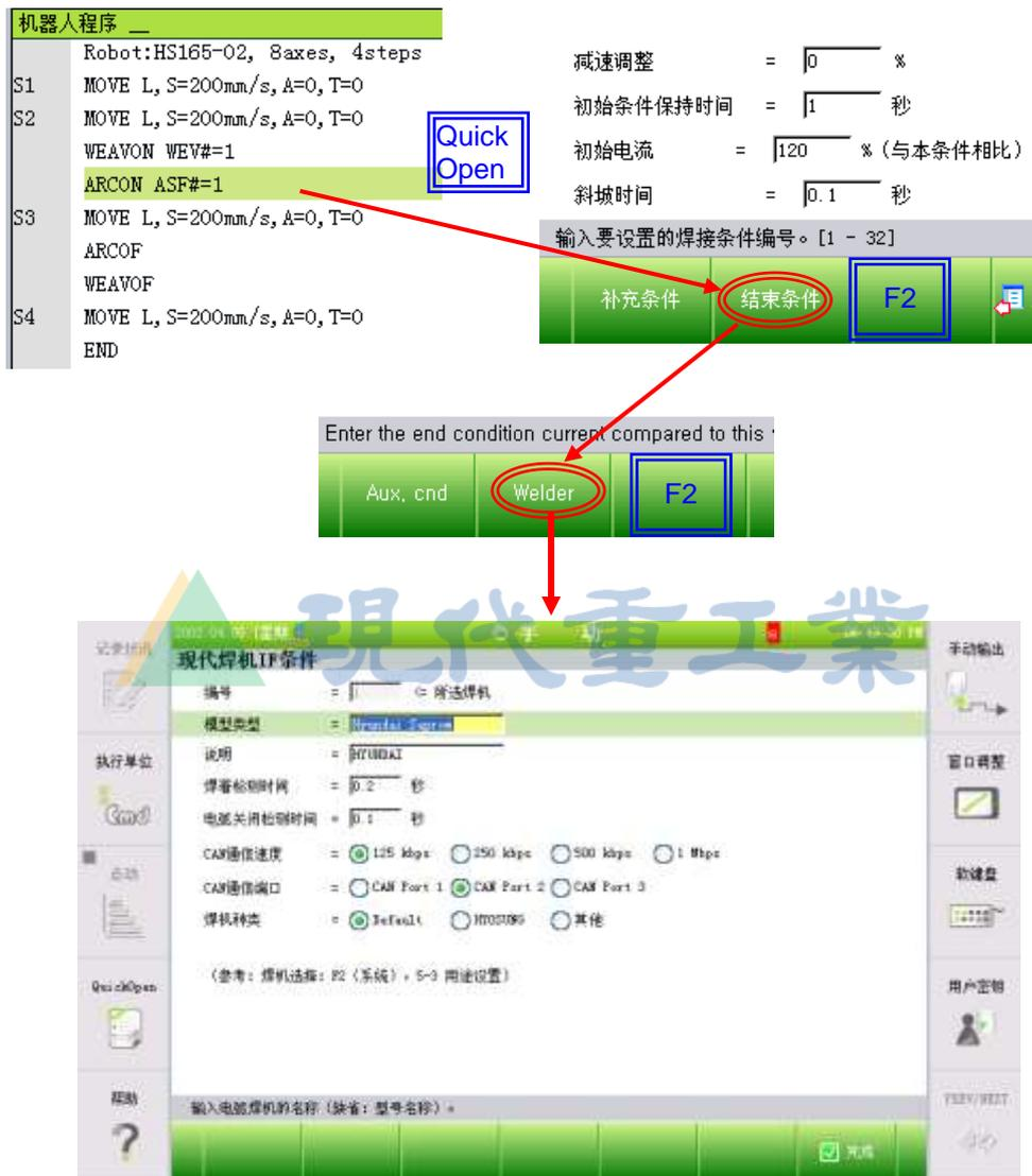
图 16.2 如何输入焊接设置对话框(数字 HRWI 例示)
