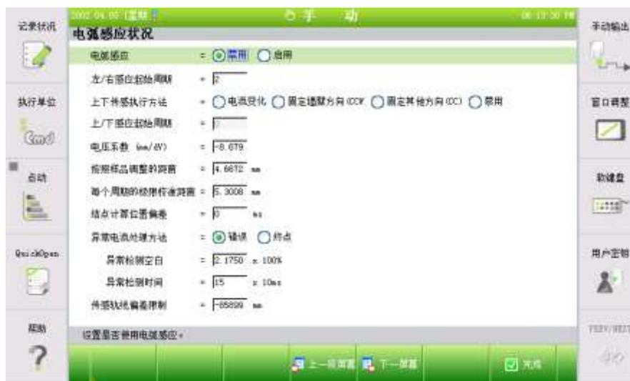
图 15.2 电弧感应对话框
