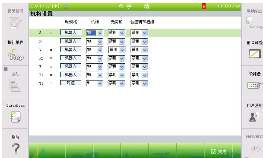
在附加轴的手动操作需要设置机械装置群组，以便按机械群组分配 Jog 键。机器人轴利用机械装置 MO 固定，附加轴分为机械装置 M1~M7 供选择。
