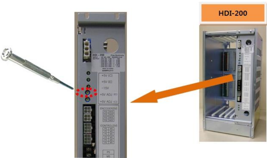
图 1.108 调整编码器电压
