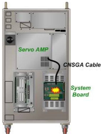
图 1.161 系统板的 PWMON 信号生成线路故障
