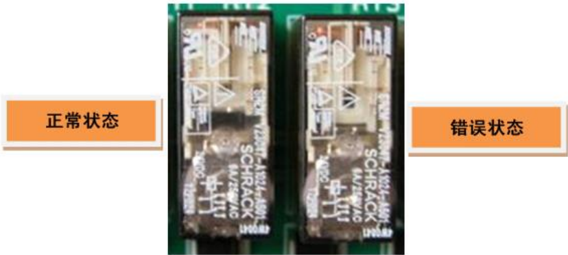
图 1.45 BD58B 板的继电器的正常与错误状态比较
