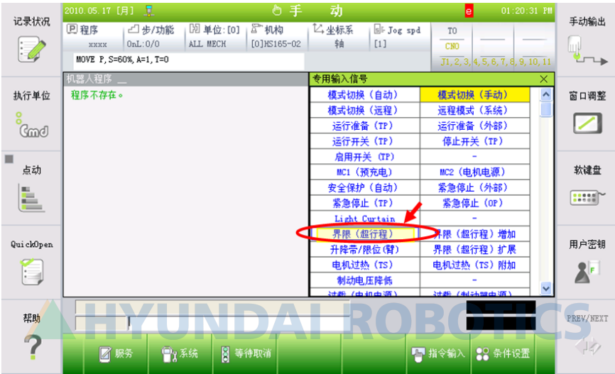
图 1.3 在专用信号输入窗显示限位(Over-Travel)监测
