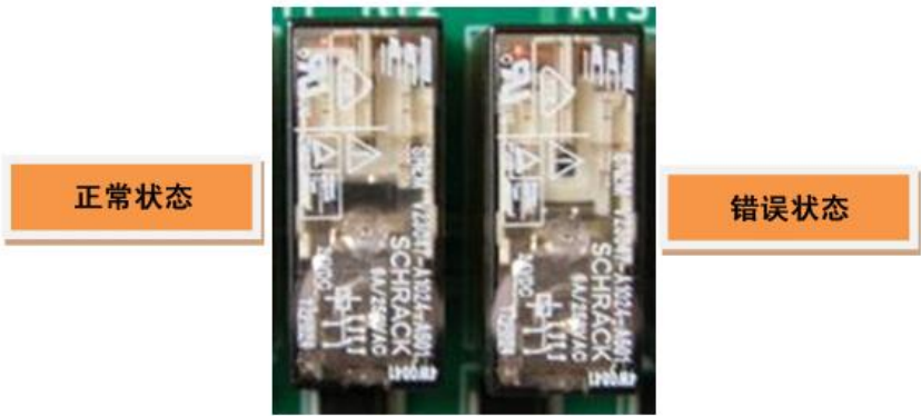
图 1.133 BD58B 板的继电器的正常与错误状态比较
