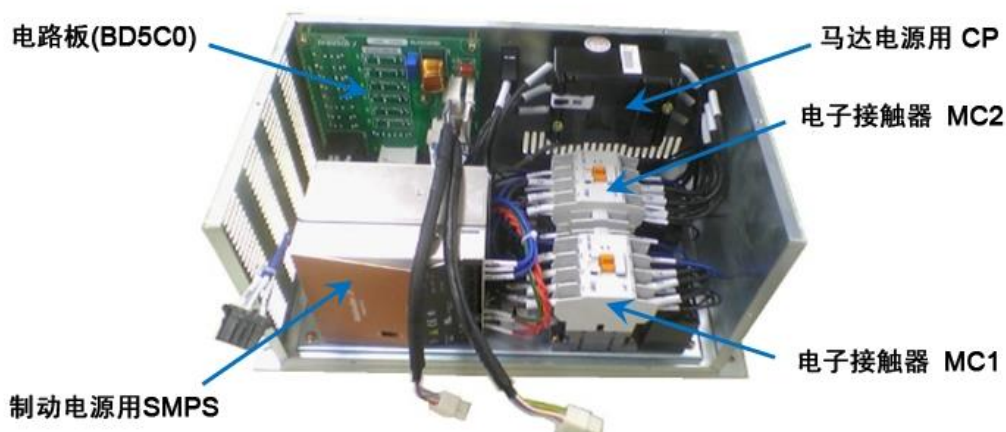
图 1.18 电气模块内部结构
