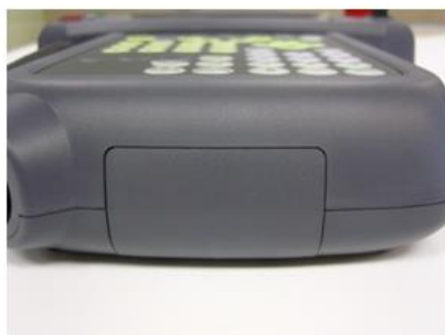
图 6.78 在 TP 插入 USB 的方法
