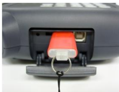
图 6.90 在 TP 插入 USB 的方法
