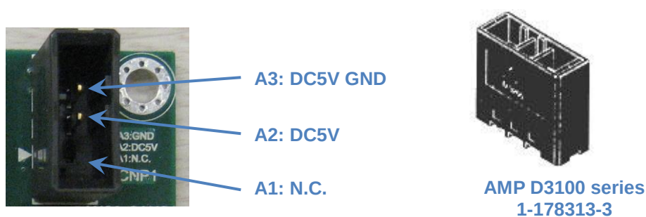
图 5.30 移送传 I/F 板(BD585)的电源连接器 CNP1
