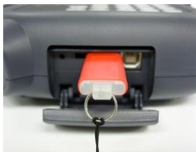
图 6.108 在 TP 插入 USB 的方法
