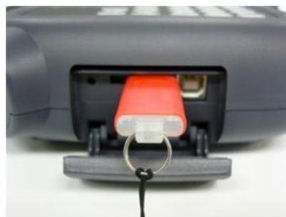
图 6.78 在 TP 插入 USB 的方法
