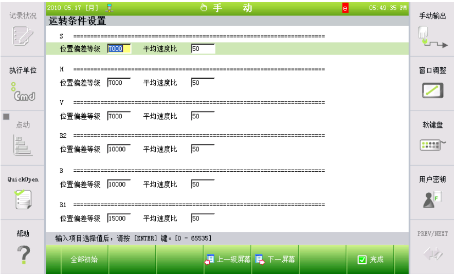
图 6.85 在 TP 的位置偏差设定值变更画面
