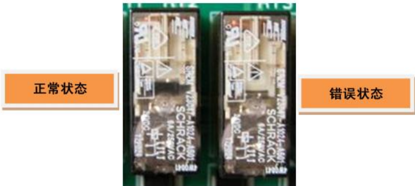
图 6.53 BD58B 板的继电器的正常与错误状态比较
