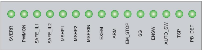
图 4.27 序列板(BD461V31)上的 LED 分布图
