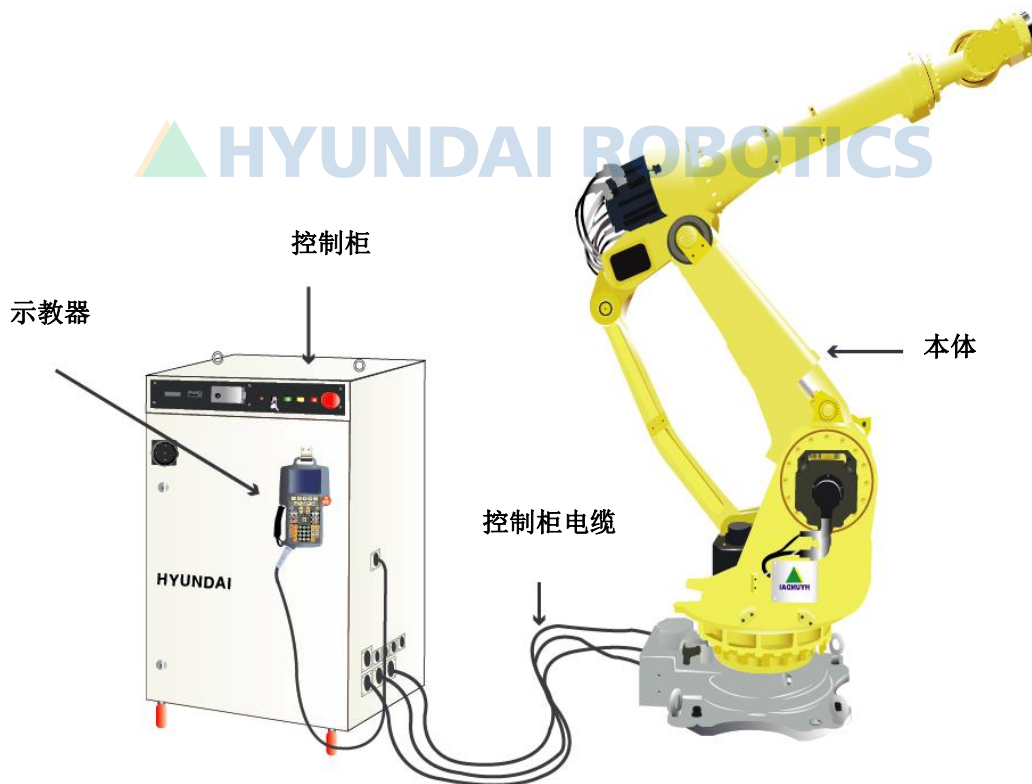
图 3.1 控制柜和本体的基本组成部分
