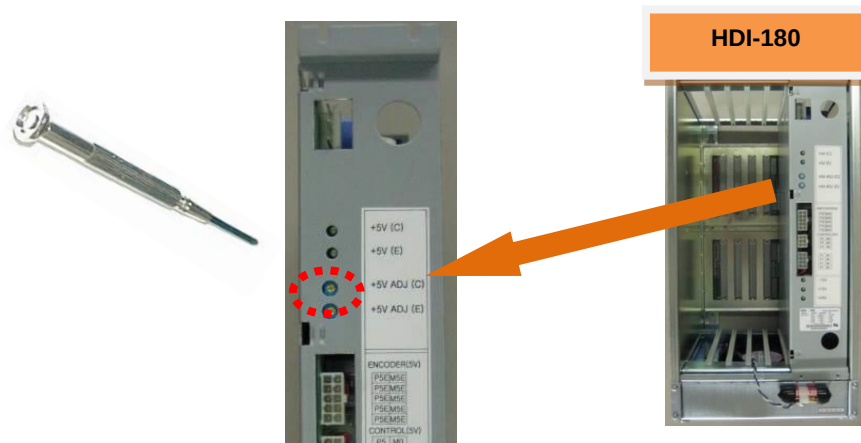
图 5.32 编码器电源的调整方法
