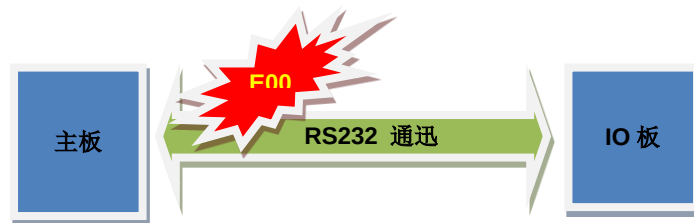
图 5.18 主板和 IO 板的通信
