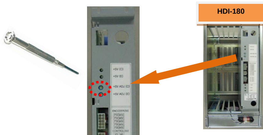
图 5.22 编码器电源的调整方法
